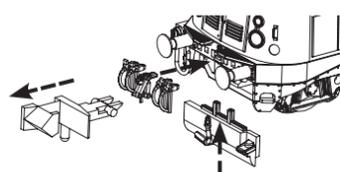
Verwendung der beiliegenden Steckteile.
